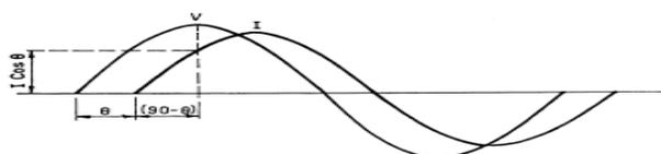
FIGURE 4.3a INSTANTANEOUS VALUE OF I AT VOLTAGE PEAK
